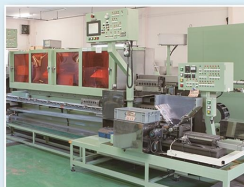
全自动NC研磨机 テープレス全自動NC研削盤
