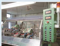
双头砂轮切割机 砥石双頭切断機
