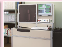
注射針刃面自動測量儀器 注射針刃形状自動計測器
