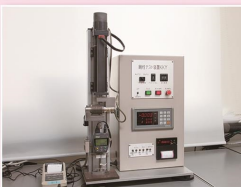
刚性測量儀器 剛性測定器
