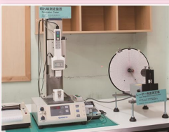
穿刺力測量儀器和激光式回轉角 度測量儀器 切れ味測定器とレーザ式回轉角測定器
