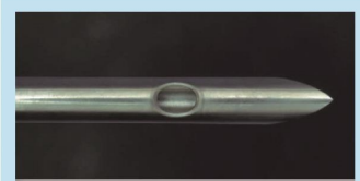
加工技术 电解加工 人工透析用AVF针
