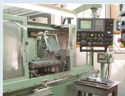
4轴马达制御研磨机 4軸NC制御研削盤
